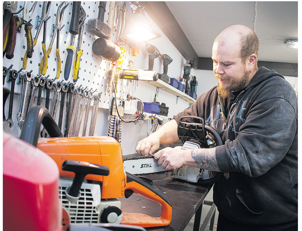
Moottorisahan huolto viimeistellään ketjun teroittamisella.
